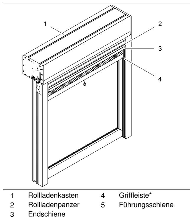
Abb. 1: Übersicht Teile Aufsetz-Rollladen Typ Au-RO
