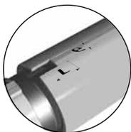
Den Antrieb dem Profil entsprechend in die Welle schieben. Achten Sie bei Verwendung eines Präzisionsrohres bitte auf die Ausklinkung für den Nocken.
