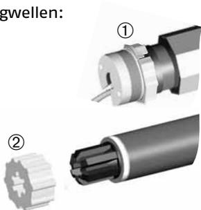
Auf den Antrieb den zur jeweiligen Antriebswelle **passenden Adapter** ① schieben. Achten Sie hierbei bitte auf den richtigen Sitz am Nocken. Anschließend den **passenden Mitnehmer** ② aufclippen.
