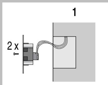
1. Anschlussleitungen werden an den Klemmen des Steckrahmens angeschlossen (Klemmenbelegung 2.2) und der Steckrahmen in der UP-Dose befestigt.
