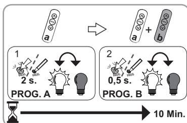
2) Druk kort op de PROG-toets van de lokale Somfy io-bediening (b) die u wilt toevoegen/wissen: de verlichting gaat aan en weer uit: de io-bediening is toegevoegd/gewist.
