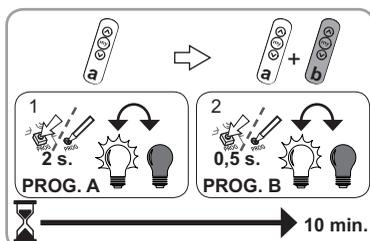
2) Faire un appui bref sur le bouton PROG du point de commande local io Somfy (b) à ajouter / à supprimer : la lumière s'allume puis s'éteint ; le point de commande io est ajouté / supprimé.
