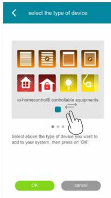
[D] Wählen Sie den Produkttyp aus, den Sie in der Anlage hinzufügen möchten: io-Antriebe/-Produkte, io-Sensoren, io-Melder oder Philips Hue-Lampen und bestätigen Sie, indem Sie auf **OK** tippen.
